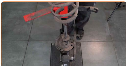
**33** Retirez l'amortisseur usagé du compresseur à ressort hydraulique hélicoïdal.
