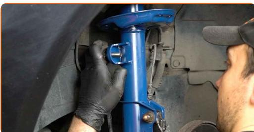
**58** Serrez la fixation reliant la biellette à l'amortisseur. Utilisez une clé mixte de No.15 Utilisez la mèche Torx T30. Utilisez une clé dynamométrique. Serrez-le jusqu'à 40 Nm.
