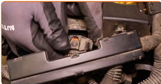
**5** Dévissez les boulons des bobines d'allumage. Utilisez la mèche Torx T40. Utilisez une clé à cliquet.
