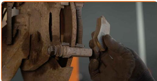
Remplacement : plaquettes de frein – OPEL COMBO (71\_). Les professionnels recommandent :
