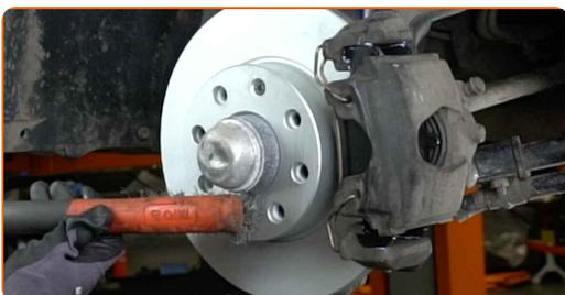
**34** Appliquez du produit sur la zone de contact entre le disque de frein et la jante. Utilisez du lubrifiant céramique à haute température.
