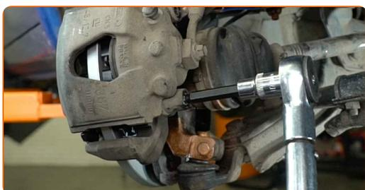
**31** Installez les bouchons anti-poussière des goupilles de guidage de l'étrier de frein.
