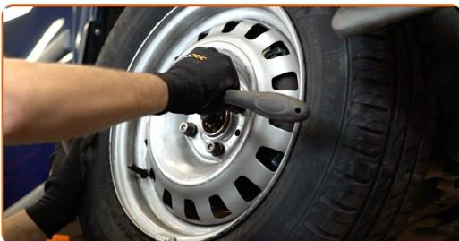
**20** Abaissez la voiture et serrez les boulons de roue en ordre croisé. Utilisez une clé dynamométrique. Serrez-le jusqu'à 110 Nm.
