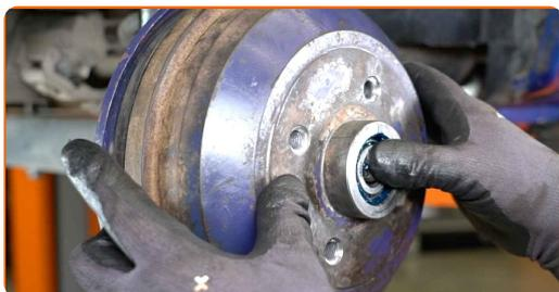
**25** Montez la rondelle du roulement de roue.
