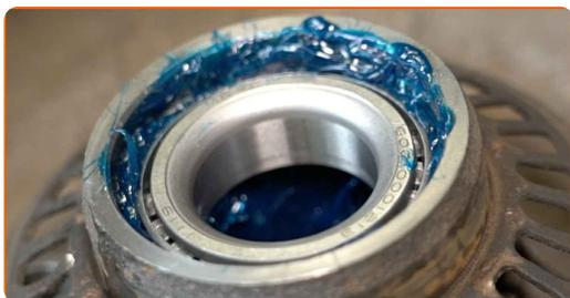
**22** Installez le joint d'huile du roulement de roue.
