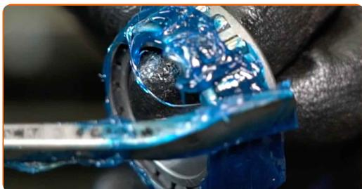
**21** Installez un nouveau roulement de moyeu et fixez-le.
