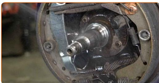
**24** Installez le tambour de frein assemblé avec le roulement du moyeu de roue.
