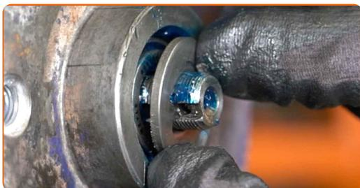
**26** Vissez l'écrou de moyeu. Utilisez une douille n° 24. Utilisez une clé à cliquet.
