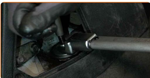
**38** Nettoyez les fixations de l'amortisseur. Utilisez de la graisse au cuivre.
