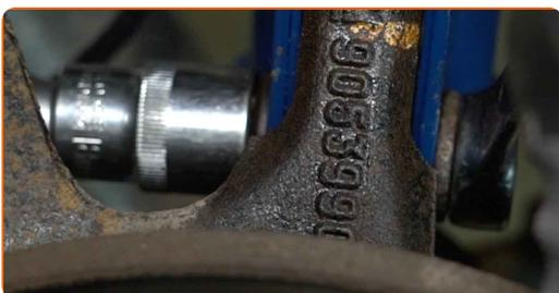
**43** Serrez les fixations inférieures qui relient l'amortisseur à la fusée d'essieu. Utilisez une clé mixte de No.18 Utilisez une douille n° 18. Utilisez une clé dynamométrique. Serrez-le jusqu'à 90 Nm.+45°+15°
