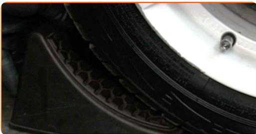
**6** Desserrez les boulons de fixation de la roue. Servez-vous d'une douille à choc pour roue N°17.
