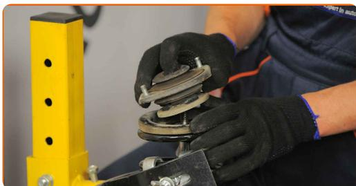
**31** Serrez l'écrou de l'entretoise d'amortisseur due la tige de piston. Utilisez une douille n° 19. Utilisez une clé dynamométrique. Serrez-le jusqu'à 55 Nm.
