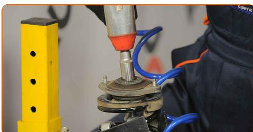
**Remplacement : ressort de suspension – OPEL Corsa B Van (S93). Conseil :**
