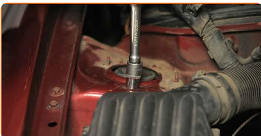
Remplacement : ressort de suspension – OPEL Corsa B Van (S93). AUTODOC recommande :
