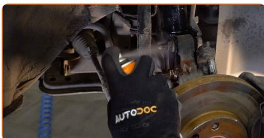
**48** Appliquez du produit sur la zone de contact entre le disque de frein et la jante. Utilisez de la graisse au cuivre.
