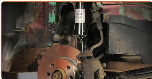
**45** Installez les boulons de fixation.
