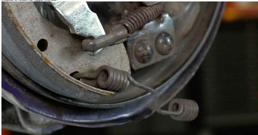
26 Retirez le ressort supérieur et le dispositif de réglage.
