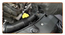
Détachez le collier de serrage de la durite d'admission d'air. Utilisez une douille n° 7. Utilisez une clé à cliquet.
