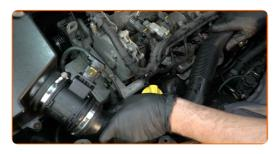
Serrez le collier de serrage sur la durite d'admission d'air. Utilisez une douille n° 7. Utilisez une clé à cliquet.
