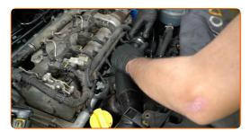
Recouvrez la durite d'admission d'air avec un chiffon microfibre pour empêcher que des particules n'entrent dans le système.
