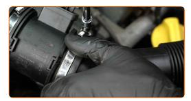
Vissez la fixation sur le tuyau d'entrée d'air. Utilisez la mèche Torx T25.
