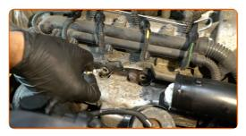
Serrez les bougies de préchauffage. Servez-vous de la douille de bougie d'allumage n°8. Utilisez une clé dynamométrique. Serrez-le jusqu'à 10 Nm.
