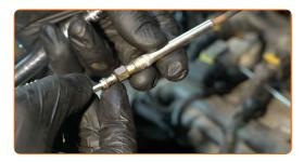
Appliquez du produit sur les bougies de préchauffage. Utilisez la graisse pour injecteurs et bougies de préchauffage.
