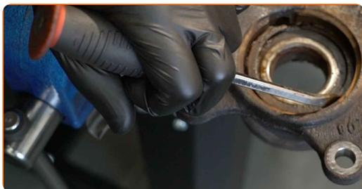
**39** Relâchez l'étau et enlevez le moyeu de roue avec le roulement.
