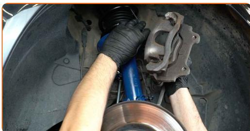
Remplacement : roulement de roue – OPEL Corsa D Van (S07). Conseil des experts d'AUTODOC :
