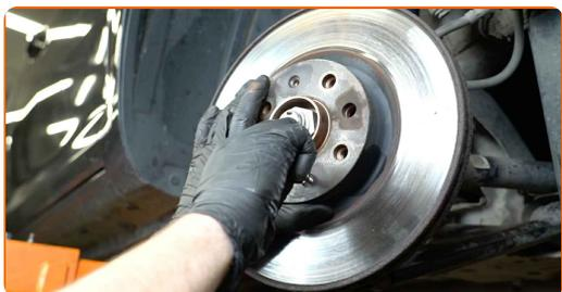
**66** Serrez l'attache du disque de frein. Utilisez la mèche Torx T30. Utilisez une clé dynamométrique. Serrez-le jusqu'à 7 Nm.
