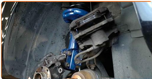
**51** Installez les boulons de fixation.
