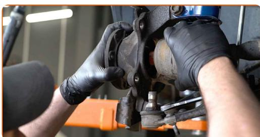
**Remplacement : roulement de roue – OPEL Corsa D Van (S07). Conseil :**
