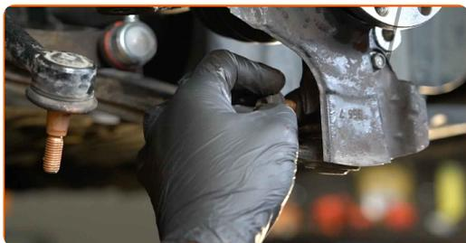
**56** Vissez les fixations de la rotule. Utilisez une clé mixte de No.16 Utilisez une douille n° 16. Utilisez un porte-taraud.
