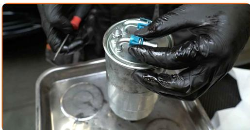
**10** Retirez le capteur de pression du carburant.
