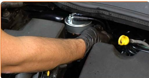
**16** Vissez le support de montage du filtre à carburant. Utilisez une douille n° 10. Utilisez une clé à cliquet.
