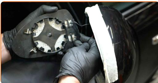
**7** Appliquez du produit sur les connecteurs de chauffage du miroir. Utilisez de la graisse diélectrique.
