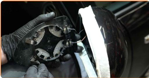
Remplacement : glace rétroviseur – OPEL Corsa E 3/5 portes (X15). Conseil :
