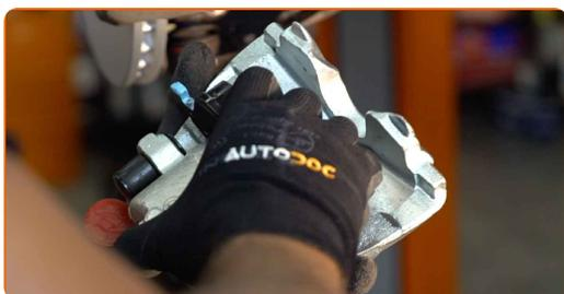
**Remplacement : étrier de frein – OPEL Corsa E Van (X15). Les professionnels recommandent :**
