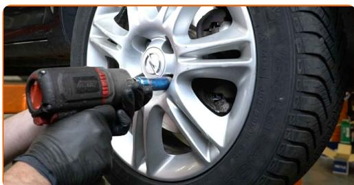
**35** Abaissez la voiture et serrez les boulons de roue en ordre croisé. Servez-vous d'une douille à choc pour roue N°17. Utilisez une clé dynamométrique. Serrez-le jusqu'à 110 Nm.
