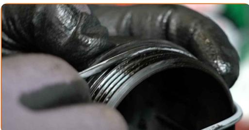
**17** Lubrifiez le joint en caoutchouc du nouveau filtre avec une petite quantité d'huile neuve.
