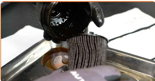
**14** Retirez la bague d'étanchéité du boîtier du filtre à huile. Utilisez un tournevis plat.
