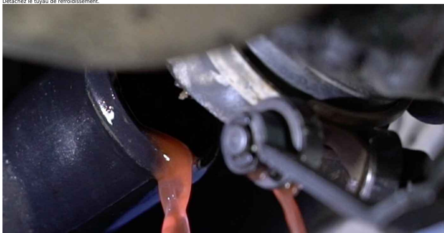
8 Détachez le tuyau de refroidissement.
