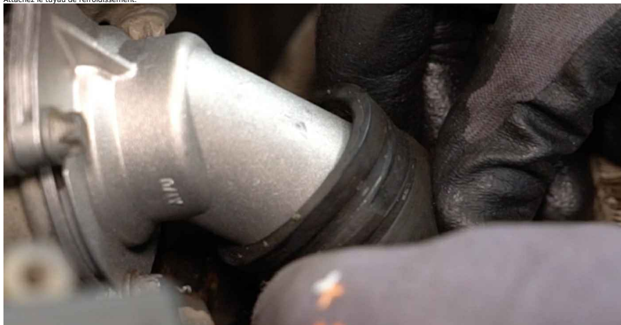
29 Fixez les colliers de serrage des tuyaux de refroidissement. Utilisez des pinces de clic-R.
