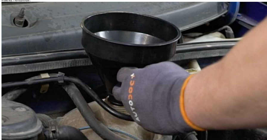
35 Versez du liquide de refroidissement dans le réservoir.
