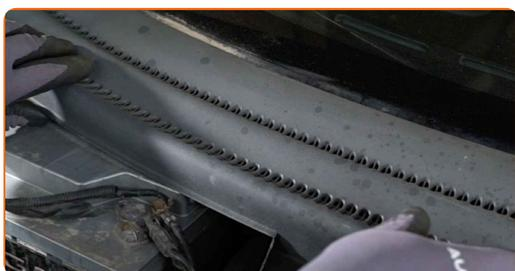
**24** Installez la grille d'auvent et fixez-la. Utilisez une douille n° 8. Utilisez une clé à cliquet. Servez-vous d'un tournevis Phillips.
