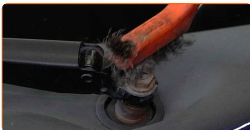
**3** Dévissez les fixations des bras d'essuie-glaces. Utilisez une douille n° 13. Utilisez une clé à cliquet.
