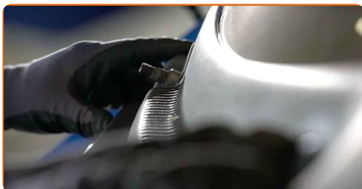
**23** Installez la grille d'auvent sur le côté gauche.
