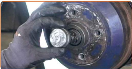
**7** Retirez la goupille fendue qui garde l'écrou du moyeu en place. Servez-vous d'un pied-de-biche. Utilisez un tournevis plat.
