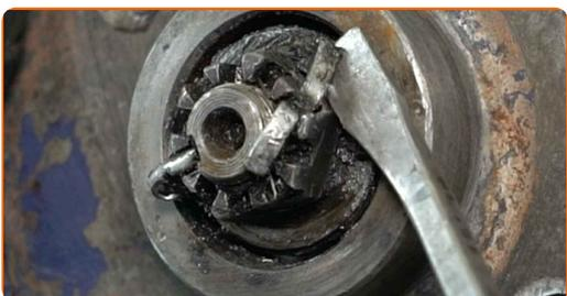
**8** Dévissez l'écrou de moyeu. Utilisez une douille n° 24. Utilisez une clé à cliquet.
