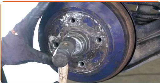
**54** Appliquez du produit sur la surface de contact entre la jante et le tambour de frein. Utilisez du lubrifiant céramique.
