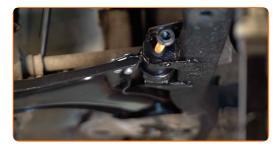
Connectez le joint rotule à la fusée d'essieu.
