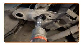
15 Retirez l'écrou de fixation.
