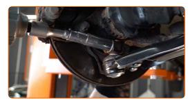
Vissez les fixations de la rotule. Utilisez une douille n° 18. Utilisez une clé mixte de No.18.
