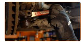
17 Retirez l'écrou de fixation.
