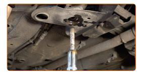
Déconnectez le joint rotule de la fusée d'essieu. Servez-vous d'un burin plat pour l'usinage des métaux. Servez-vous d'un marteau.
