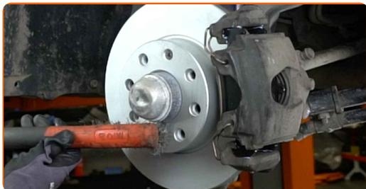
**22** Appliquez du produit sur la zone de contact entre le disque de frein et la jante. Utilisez du lubrifiant céramique à haute température.
