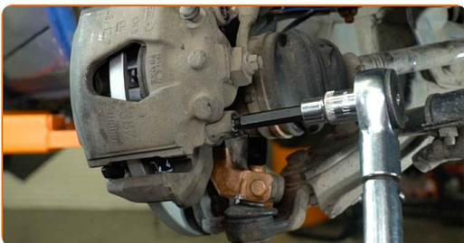
**19** Installez les bouchons anti-poussière des goupilles de guidage de l'étrier de frein.
