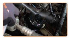
Dévissez le bouchon du compartiment du filtre, ainsi que l'ancien élément filtrant. Utilisez une douille n° 32. Utilisez une clé à cliquet.
