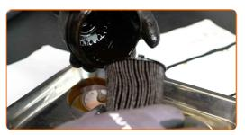
Retirez la bague d'étanchéité du boitier du filtre à huile. Utilisez un tournevis plat.
