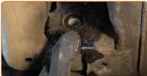
**12** Détendez les fixations reliant le joint à rotule du bras de commande à la fusée d'essieu. Servez-vous d'un burin plat pour l'usinage des métaux. Servez-vous d'un marteau.
