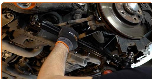
Remplacement : bras inférieur avant – OPEL VECTRA B 3/5 portes (38\_). Les experts d'AUTODOC recommandent :
