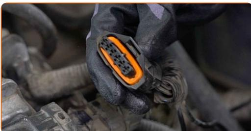
**4** Dévissez les boulons des bobines d'allumage. Utilisez la mèche Torx T30. Utilisez une clé à cliquet.
