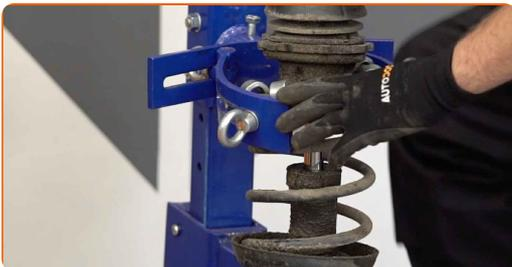
Remplacement : coupelle d'amortisseur – OPEL Vectra B CC (J96). Les experts d'AUTODOC recommandent :
