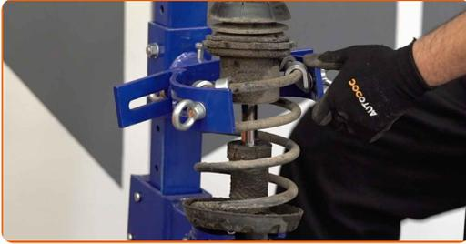
22 Retirez l'écrou de la tige de piston de l'entretoise. Utilisez une clé mixte de No.19 Utilisez une douille n° 9.
