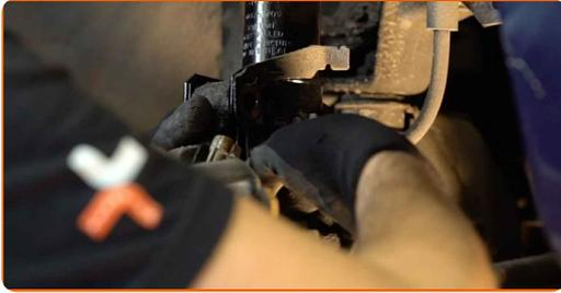
33 Serrez les fixations inférieures qui relient l'amortisseur à la fusée d'essieu. Utilisez une clé mixte de No.18. Utilisez une douille n° 18. Utilisez une clé dynamométrique. Serrez-le jusqu'à 90 Nm.+45°
