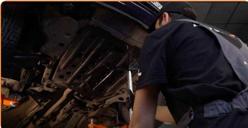
5 Défaites les attaches du carénage sous moteur. Utilisez une douille n° 12.
