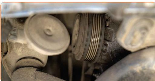
Remplacement : courroie poly V – OPEL Vectra C Caravan (Z02). Les experts d'AUTODOC recommandent :
