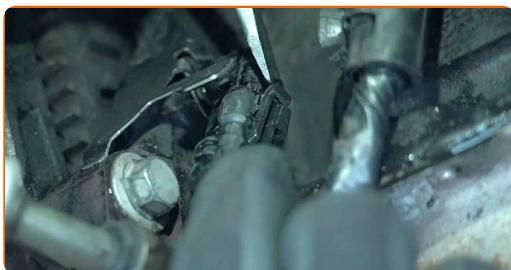
**4** Appuyez sur le ressort de retenue du capteur de position du vilebrequin. Utilisez un levier de montage.
