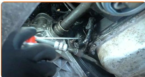
**3** Débranchez le connecteur du capteur de position du vilebrequin. Utilisez un levier de montage.
