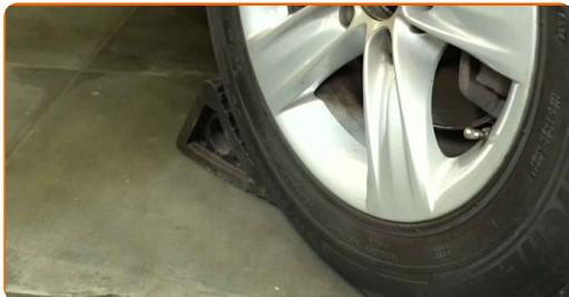
2 Desserrez les fixations de la roue. Utilisez une douille à choc pour jantes de 19 mm. Utilisez une barre de force.
