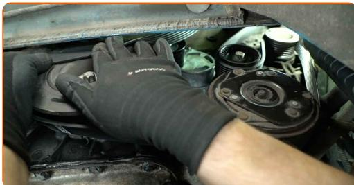
Remplacement : courroie poly V – OPEL Vivaro A Van (X83). Les professionnels recommandent :
