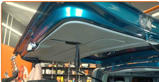
**3** Dévissez les fixations du troisième feu stop. Utilisez une douille de 8 mm. Utilisez une clé à cliquet.
