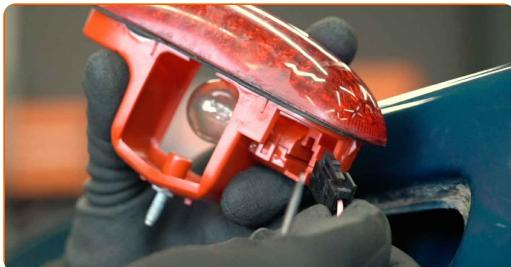
Remplacement : feu stop additionnel – OPEL Vivaro A Van (X83). Les experts d'AUTODOC recommandent :
