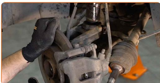
**28** Dévissez l'attache supérieure du support de l'amortisseur. Utilisez une douille n° 22.
