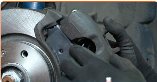
**19** Installez les boulons de fixation.
