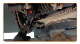
9 Retirez l'écrou de fixation.
