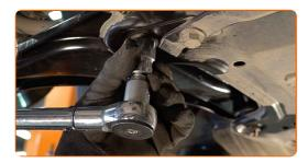
Serrez la fixation arrière du bras de suspension. Utilisez une douille n° 18. Utilisez une clé dynamométrique. Serrez-le jusqu'à 120 Nm.
