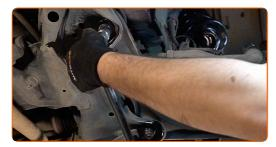
Desserrez la fixation avant du bras de suspension. Utilisez une douille n° 18. Utilisez un porte-taraud.
