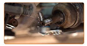
Montez l'arbre de transmission sur le moyeu de roue.
