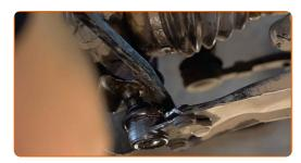
Dévissez les fixations qui lient l'arbre de transmission au moyeu de roue.
