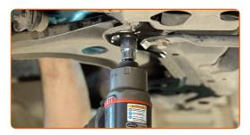
18 Retirez l'écrou de fixation.
