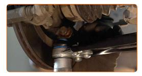
Vissez la fixation reliant le joint à rotule au porte-fusée. Utilisez une douille n° 16. Utilisez une douille n° E8. Utilisez une clé à cliquet.
