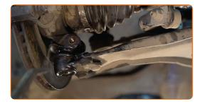
Desserrez la fixation arrière du bras de suspension. Utilisez une douille n° 18. Utilisez un porte-taraud.
