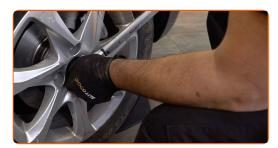
Serrez en étoile les boulons de la roue. Utilisez une clé dynamométrique. Serrez-le jusqu'à 100 Nm.
