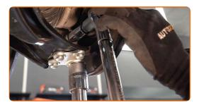
Serrez la fixation avant reliant le bras de commande au sous-châssis. Utilisez une douille n° 18. Utilisez une clé dynamométrique. Serrez-le jusqu'à 120 Nm.
