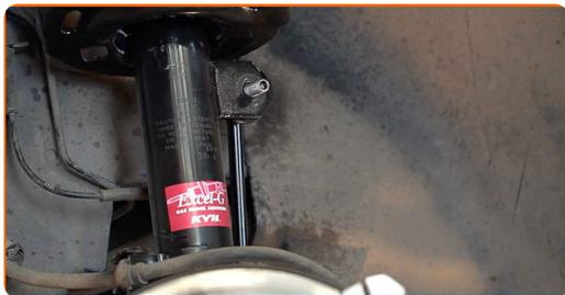
**11** Serrez la fixation reliant la biellette à la barre stabilisatrice. Utilisez une douille n° 16. Utilisez une clé dynamométrique. Serrez-le jusqu'à 43 Nm.
