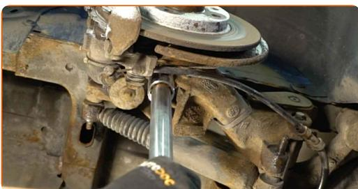
**11** Retirez l'écrou de fixation.
