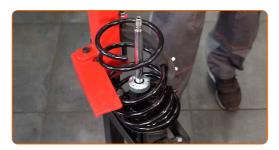
Serrez l'écrou de l'entretoise d'amortisseur due la tige de piston. Utilisez une douille n° 21. Utilisez la clé HEX n° H7. Utilisez une clé dynamométrique. Serrez-le jusqu'à 45 Nm.
