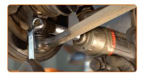
20 Retirez l'écrou de fixation.
