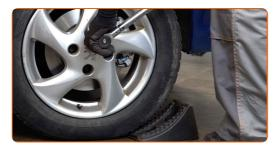
Serrez l'attache supérieure de l'entretoise de support de l'amortisseur. Utilisez une douille n° 13. Utilisez une clé dynamométrique. Serrez-le jusqu'à 25 Nm.
