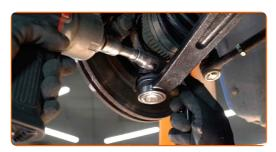
Serrez l'attache du joint rotule. Utilisez une douille n° 17. Utilisez une clé mixte de No.17 Utilisez une clé dynamométrique. Serrez-le jusqu'à 40 Nm.
