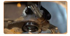
Serrez le collier de serrage du flexible de frein de l'entretoise de l'amortisseur. Utilisez une douille n° 13. Utilisez une clé à cliquet.
