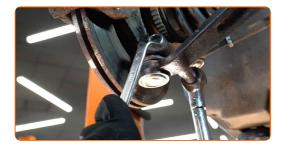
Serrez les fixations inférieures qui relient l'amortisseur à la fusée d'essieu. Utilisez une douille n° 18. Utilisez une clé dynamométrique. Serrez-le jusqu'à 55 Nm.
