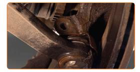
Nettoyez les fixations assurant la connexion entre la jambe d'amortisseur et le porte-fusée. Utilisez une brosse métallique. Servez vous de l'aérosol WD-40.
