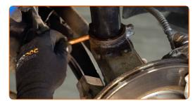
Vissez la fixation qui relie la jambe d'amortisseur à la fusée d'essieu. Utilisez une douille n° 18.
