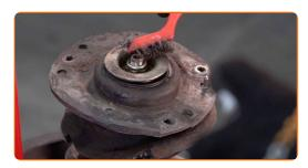
Retirez l'écrou de la tige de piston de l'entretoise. Utilisez une douille n° 21. Utilisez la clé HEX n° H7. Utilisez une clé à cliquet.
