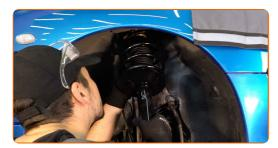
Vissez l'attache supérieure du support de l'amortisseur. Utilisez une douille n° 13. Utilisez une clé à cliquet. Ne serrez pas trop.
