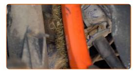
Dévissez la fixation reliant la biellette à l'amortisseur. Utilisez une douille n° 16. Utilisez la mèche Torx T30. Utilisez une clé à cliquet.
