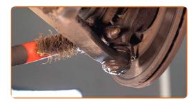
Dévissez l'attache entre le joint rotule et la fusée d'essieu. Utilisez une clé mixte de No.17 Utilisez une douille n° 17.
