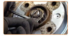
Desserrez la fixation de l'arbre de transmission. Utilisez une douille n° 32. Utilisez un porte-taraud. Servez-vous d'un pied-de-biche.
