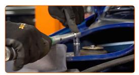
Lubrifiez les fixations de la coupelle d'amortisseur. Utilisez de la graisse au cuivre.
