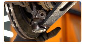
62 Installez l'écrou de fixation.
