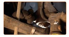
Dévissez le collier de serrage flexible de frein de l'entretoise de l'amortisseur. Utilisez une douille n° 13. Utilisez une clé à cliquet.
