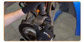
Dévissez l'attache supérieure du support de l'amortisseur. Utilisez une douille n° 13. Utilisez une clé à cliquet.
