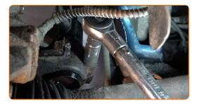
Installez la barre stabilisatrice transversale. Utilisez une douille n° 16.
