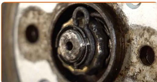
**40** Appliquez du produit sur la zone de contact entre le disque de frein et la jante. Utilisez de la graisse au cuivre.
