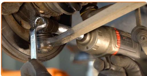
**14** Retirez l'écrou de fixation.
