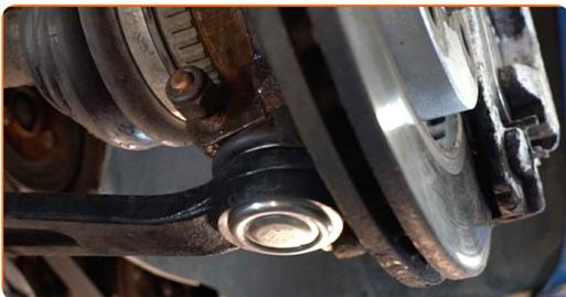
**33** Vissez les fixations de la rotule. Utilisez une douille n° 17. Utilisez une clé mixte de No.17
