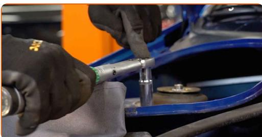
**76** Lubrifiez les fixations de la coupelle d'amortisseur. Utilisez de la graisse au cuivre.
