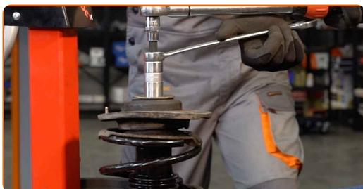
Remplacement : ressort de suspension – PEUGEOT 206 Van. Les professionnels recommandent :
