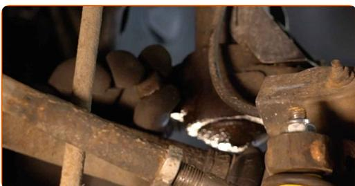
**28** Dévissez le collier de serrage flexible de frein de l'entretoise de l'amortisseur. Utilisez une douille n° 13. Utilisez une clé à cliquet.
