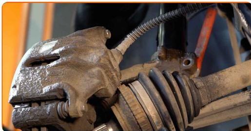
**55** Installez l'écrou de fixation.
