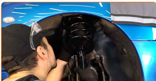
**52** Vissez l'attache supérieure du support de l'amortisseur. Utilisez une douille n° 13. Utilisez une clé à cliquet. Ne serrez pas trop.
