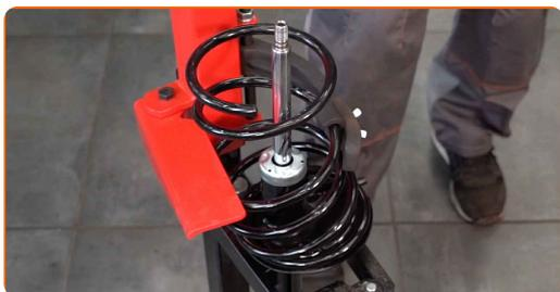
**48** Serrez l'écrou de l'entretoise d'amortisseur due la tige de piston. Utilisez une douille n° 21. Utilisez la clé HEX n° H7. Utilisez une clé dynamométrique. Serrez-le jusqu'à 45 Nm.
