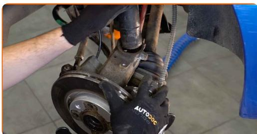
**33** Dévissez l'attache supérieure du support de l'amortisseur. Utilisez une douille n° 13. Utilisez une clé à cliquet.
