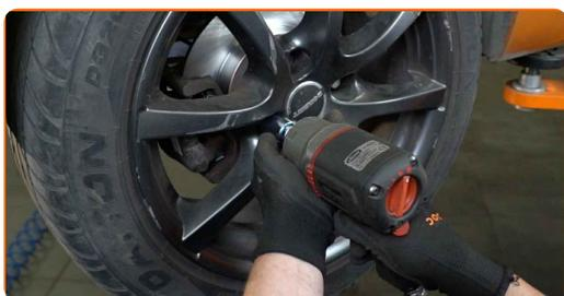
**34** Abaissez la voiture et serrez les boulons de roue en ordre croisé. Servez-vous d'une douille à choc pour roue N°17. Utilisez une clé dynamométrique. Serrez-le jusqu'à 100 Nm.
