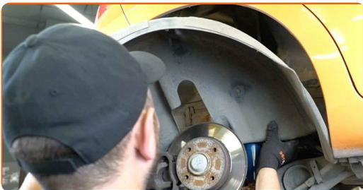
**28** Réinstallez les clips en plastique de la garniture du passage de roue.
