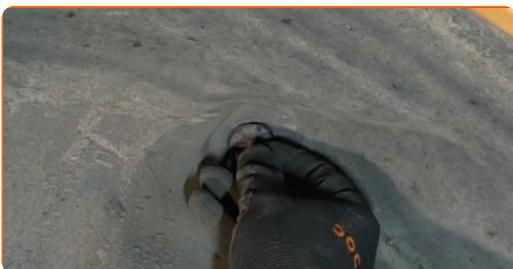
**29** Nettoyez les fixations de l'amortisseur. Utilisez de la graisse au cuivre.
