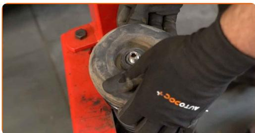
**48** Serrez l'écrou de l'entretoise d'amortisseur due la tige de piston. Utilisez une douille n° 19. Utilisez la clé HEX n° H6. Utilisez une clé dynamométrique. Serrez-le jusqu'à 75 Nm.
