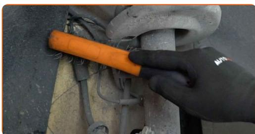
**13** Dévissez la fixation reliant la biellette à l'amortisseur. Utilisez une clé mixte de No.16 Utilisez la mèche Torx T30. Utilisez une clé à cliquet.
