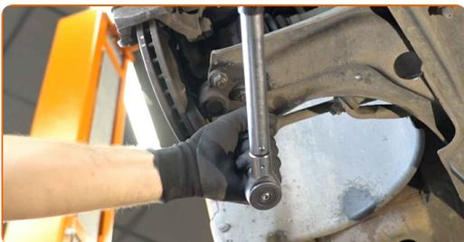
**65** Serrez les fixations inférieures qui relient l'amortisseur à la fusée d'essieu. Utilisez une douille n° 16. Utilisez une clé dynamométrique. Serrez-le jusqu'à 55 Nm.
