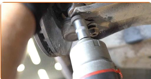
**64** Serrez les fixations reliant le joint à rotule au bras de commande. Utilisez une douille n° 16. Utilisez une clé dynamométrique. Serrez-le jusqu'à 65 Nm.
