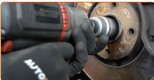
**68** Resserrez l'écrou de l'arbre de transmission. Utilisez une douille n° 35. Utilisez une clé dynamométrique. Serrez-le jusqu'à 245 Nm.
