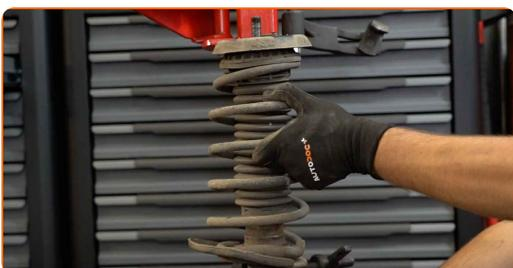
Remplacement : jambe de suspension – PEUGEOT 207 SW. AUTODOC recommande :
