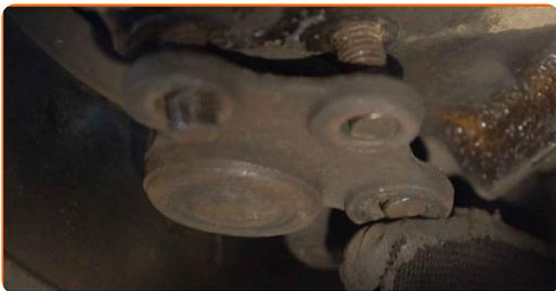
**63** Vissez les fixations de la rotule. Utilisez une clé mixte de No.17 Utilisez une douille n° 16. Utilisez une clé à cliquet.
