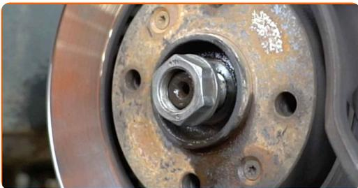
**67** Vissez l'écrou à l'arbre d'entraînement. Utilisez une douille n° 35. Utilisez une clé à cliquet.
