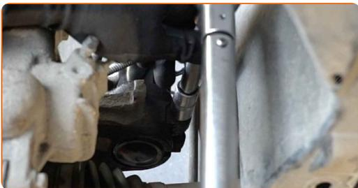
**66** Installez l'écrou de fixation.
