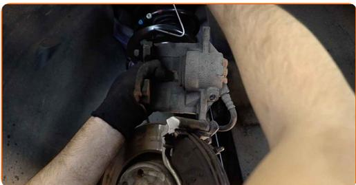
Remplacement : disques de frein – PEUGEOT 208 Van (CR\_). AUTODOC recommande :
