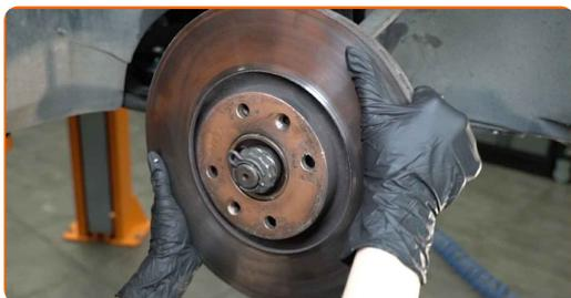
**21** Nettoyez le moyeu. Utilisez une brosse métallique. Traitez la surface de contact. Utilisez de la graisse au cuivre.
