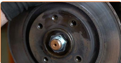
**74** Installez les boulons de fixation.
