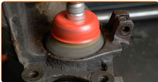
**48** Appuyez sur le roulement neuf pour l'insérer dans la fusée d'essieu. Coffret de douilles et de roulements.
