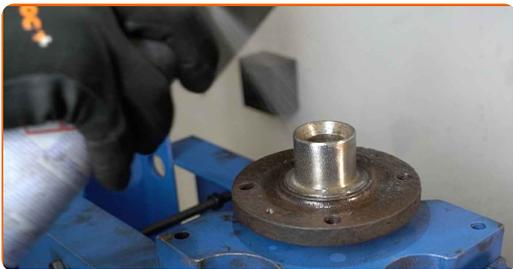
**51** Installez le moyeu de roue sur la fusée d'essieu. Coffret de douilles et de roulements.
