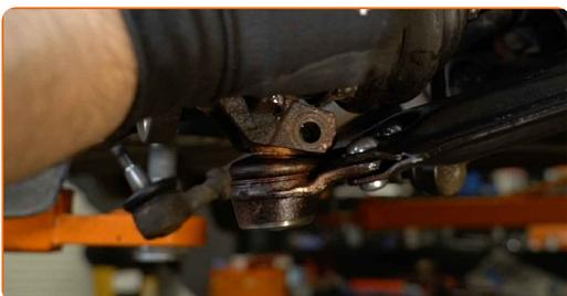
**62** Installez l'écrou de fixation.
