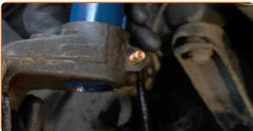
**59** Appliquez du produit sur les cannelures de joint de l'arbre de transmission. Utilisez de la graisse au cuivre.
