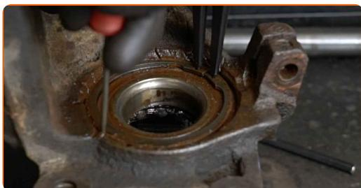
**45** Démontez la bague de roulement intérieure qui reste sur le moyeu. Coffret de douilles et de roulements. Utilisez un séparateur de roulement.
