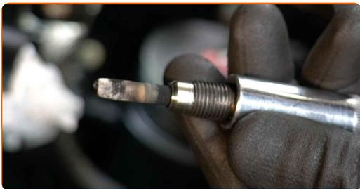
**16** Appliquez du produit sur les bougies de préchauffage. Utilisez du lubrifiant céramique à haute température.
