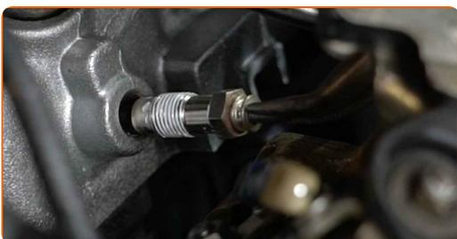
**18** Serrez les bougies de préchauffage. Servez-vous de la douille de bougie d'allumage n°12. Utilisez une clé dynamométrique. Serrez-le jusqu'à 25 Nm.
