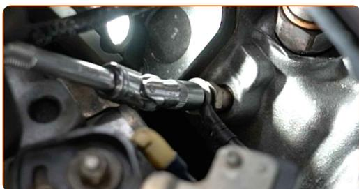
**11** Retirez les écrous de fixation. Servez-vous du doigt magnétique télescopique.
