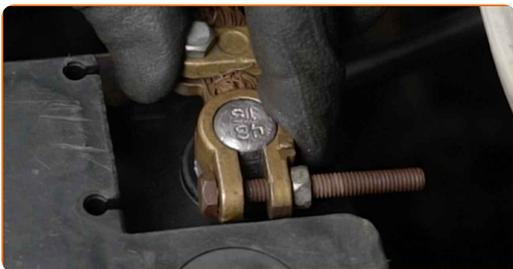
**26** Vissez la fixation de la borne négative de la batterie. Utilisez une clé mixte de No.10.
