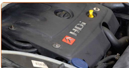
**24** Vérifiez le niveau d'huile cinq minutes après l'arrêt du moteur à l'aide d'une jauge, et ajoutez de l'huile si nécessaire.
