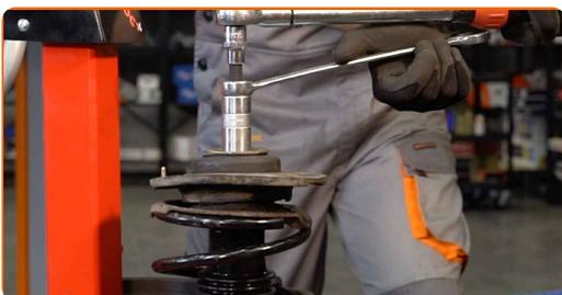
Remplacement : ressort de suspension – PEUGEOT 306 3/5 portes. Les professionnels recommandent :
