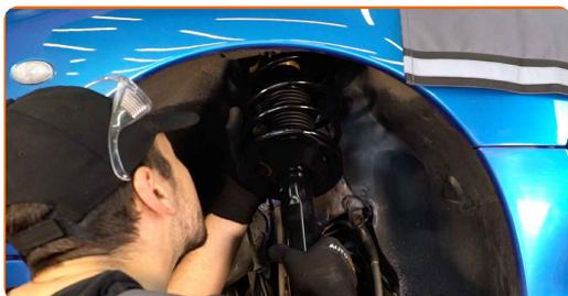
**50** Vissez l'attache supérieure du support de l'amortisseur. Utilisez une douille n° 13. Utilisez une clé à cliquet. Ne serrez pas trop.
