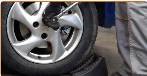
**75** Serrez l'attache supérieure de l'entretoise de support de l'amortisseur. Utilisez une douille n° 13. Utilisez une clé dynamométrique. Serrez-le jusqu'à 25 Nm.
