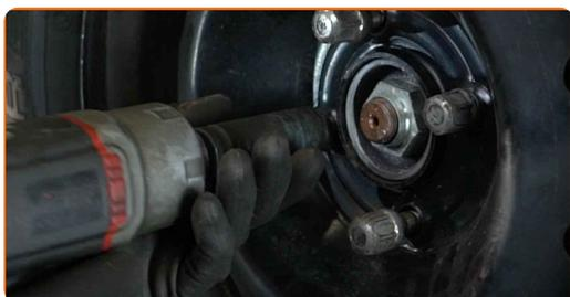
**21** Abaissez la voiture et serrez les boulons de roue en ordre croisé. Servez-vous d'une douille à choc pour roue N°19. Utilisez une clé dynamométrique. Serrez-le jusqu'à 90 Nm.
